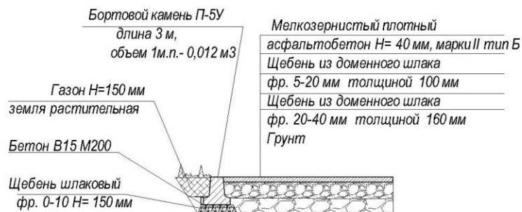
Схема 3 Конструкция покрытия тротуара Примыкание к газону
